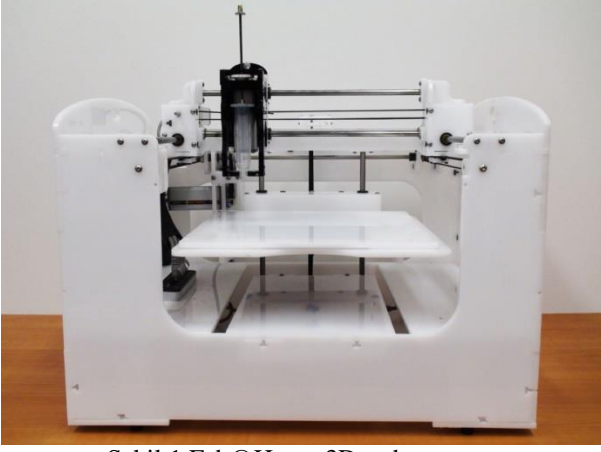
Şekil 1 Fab@Home 3D gıda yazıcısı
