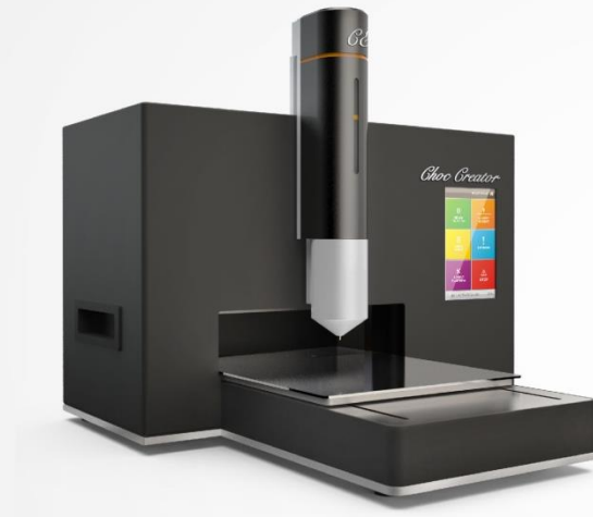
Şekil 2 ChocEdge - Choc Creator 3D gıda yazıcısı
