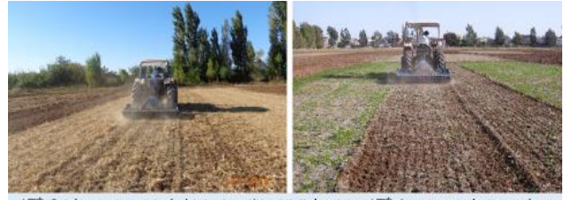
ATI-2 işleme yönteminde birinci ve ikinci ürünler için, ATI-1 yönteminde ise sadece ikinci ürün için toprak işlemede kullanılan rototiller
