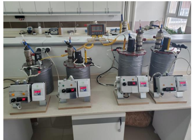
Şekil 1. (A) Biyometan potansiyelinin belirlenmesinde kullanılan biyoreaktörlerin şematik gösterimi, (B) BMP deney düzeneği.
