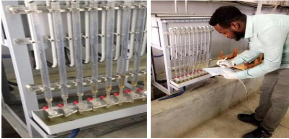
Şekil 2. Hidrolik iletkenliğin ölçülmesi Figure 2. Measurement of hydraulic conductivity
