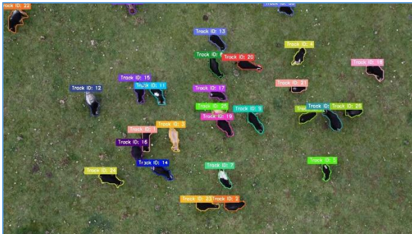
Şekil 8. Yolov8s modelinin keçileri A) tespit ve B) takip başarısına ilişkin gerçek bir uçuş videosu kare örneği.
