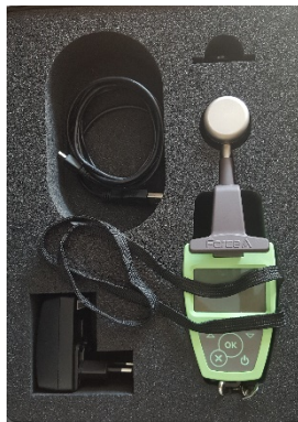
Resim 1 Force-A Dualex Scientific el sensörünün çalışma prensibi (ITK, 2022) Image 1 Working principle of Force-A Dualex Scientific hand sensor (ITK, 2022)
