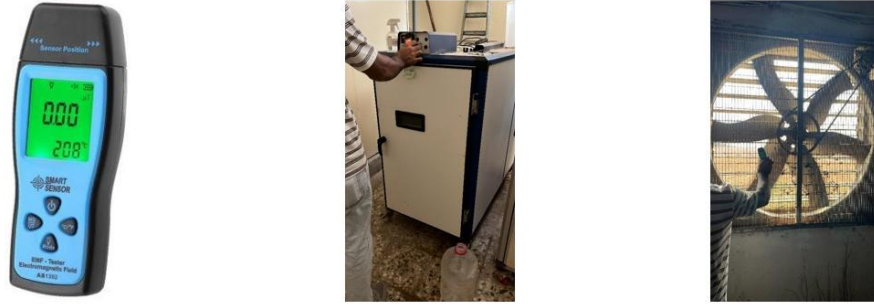
Şekil 2. Kullanılan manyetik alan ölçüm cihazı ile elektrik kumanda kabini ve havalandırma fanı çevresindeki temsili ölçüm noktaları
